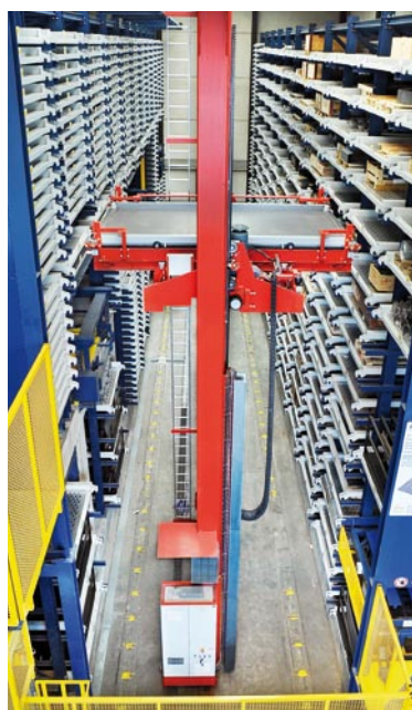
Das Regalbediengerät verfügt über ein Zahnstangenhubwerk.
